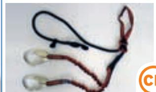
Beim Normversuch und bei Nässe deutlich über den geforderten Werten der Norm (nass 9,2 kN bei 133 cm Bremsweg)
