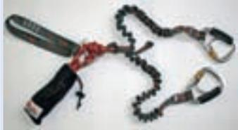
Das Set ist an der Belastungsgrenze. Störeinflüsse wie Verdrehungen der Reepschnur in der Bremse, Schlaufen im Bremsseil und Nässe könnten zum Teil- oder Komplettreiss des Sets führen.
