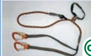
O.k. beim Normversuch; leicht über den Normwerten bei Nässe (nass 6,9 kN bei 133 cm Bremsweg)
