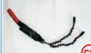
Das Set ist definitiv nur bis 55 kg zu verwenden; bei 80 kg ist das Set überlastet! Entspricht nicht der Norm. Beim Normversuch mit 80 kg kam es zu einem Bruch. Bei Nässe sehr hohe Fangstoßwerte (11,8 kN). Das 55-kg-Set und das Erwachsenenset sind optisch nur schwer zu unterscheiden!
