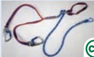
O.k. beim Normversuch; hoher Fangstoß bei Nässe; (nass 9,0 kN bei 138 cm Bremsweg)
