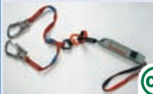
O.k. beim Normversuch; Komplettreiss bei Nässe
