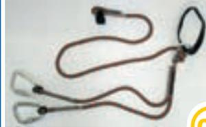
Alle Sets besitzen die gleichen Bremsen; beim Normversuch leicht über der Norm; hoher Fangstoß bei Nässe (8 kN bei 145 cm Bremsweg). Modelle „classic“, „elite“ und „rewind“ reißen bei einer 180°-Belastung zwischen 2 und 2,6 kN, bei „light“ ist kein Komplettversagen zu erwarten.
