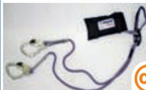
Beim Normversuch und bei Nässe über den Grenzwerten (Norm 6,7 kN bei 176 cm; nass 7,6 kN bei 187 cm); Länge des Bremswegs stark über der Norm
