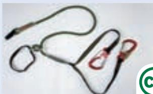
O.k. beim Normversuch; leicht über Normwert bei Nässe (6,8 kN bei 112 cm); Riss bei 180°-Belastung zwischen 1,2 und 2,6 kN
