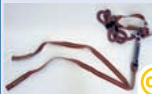
Beim Normversuch leicht, bei Nässe deutlich über den geforderten Werten der Norm (nass 9,3 kN bei 126 cm Bremsweg)
